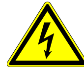
Abbildung 25 – Gefahr durch unter Spannung stehende Anlagenteile (KennV)
